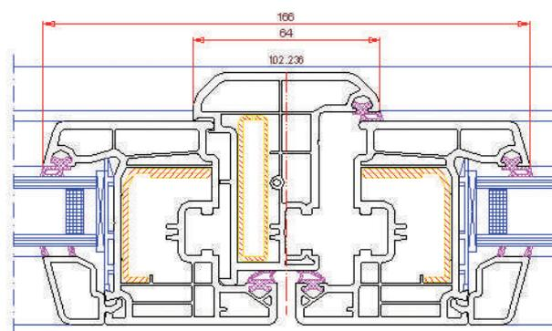
Sistema de perfiles de diseño suave y aristas redondeadas para ventanas y puertas balconeras practicables u oscilobatientes de 70 mm de profundidad y 5 cámaras interiores en hoja y marco. Los perfiles de marco, hoja y travesaño, gracias a su gran resistencia, alta estanquidad, fácil elaboración y larga vida útil, permiten fabricar elementos de grandes dimensiones.
